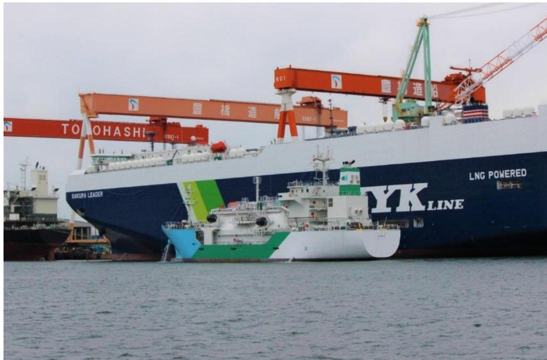
※岸壁・棧橋に係留中又は錨泊中の船舶にバンカリング船が接舷(横付け)して燃料を供給する方法
